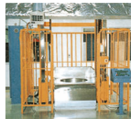
直接投入型リフト装置
