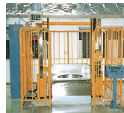
直接投入型リフト装置
