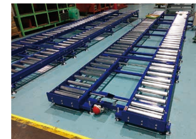
フリーローラ傾斜切り出し装置付
