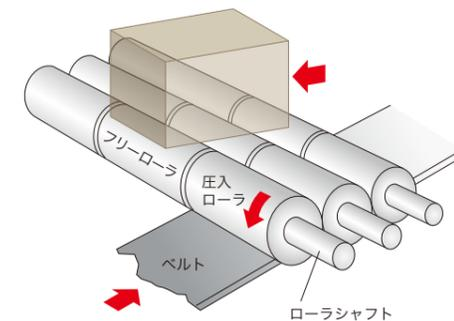
ローラシャフトに圧入ローラ1ヶを圧入固定し、フリーローラ数個をシャフトに差し込み、圧入ローラと駆動ベルトとの摩擦によりローラシャフトを回転させ、搬送物の重量とフリーローラとシャフトの摩擦係数によって搬送力が生まれます。
