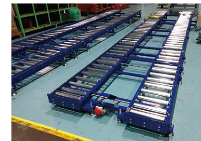
フリーローラ傾斜切り出し装置付
