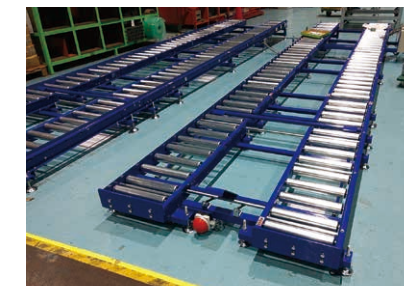
フリーローラ傾斜切り出し装置付
